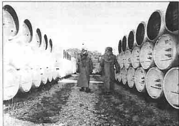
Fasslagerbereich des CASY. Jeder der 1800 Container enthält 1 t Lost (die Aufschrift HD ist die militärische Bezeichnung) – das ist allerdings nur ein kleiner Teil der in den USA zu vernichtenden Lost-Menge. (Bildquelle: Homepage des Arsenal)
